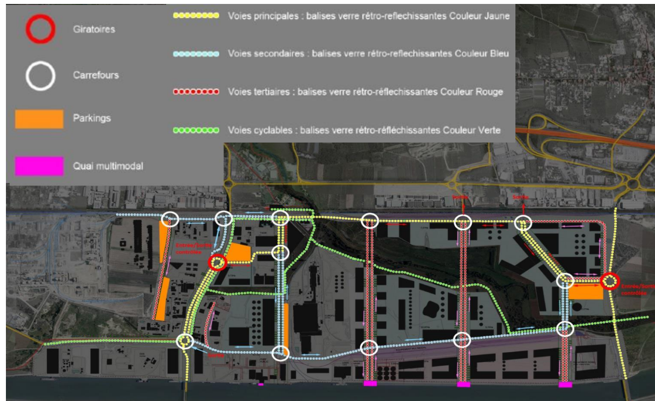
Figure 77 : Éclairage des points de conflits et des parkings
