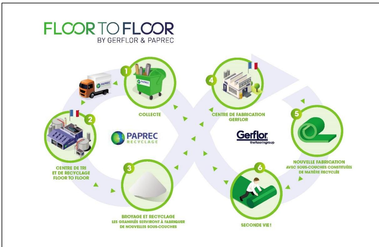
Figure 1 : Infographie du projet FLOOR TO FLOOR (Scs : Documentation commerciale FLOOR TO FLOOR)
