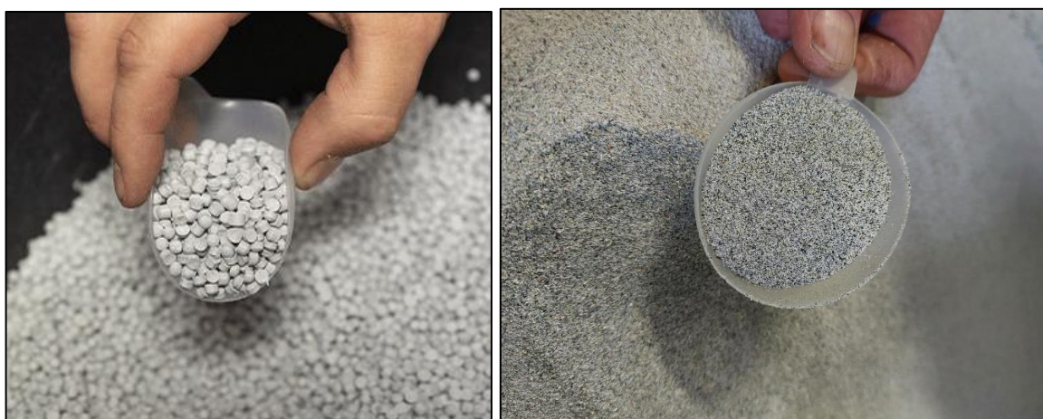
Figure 89 : PVC recyclé par régénération (à gauche) et micronisation (à droite) (©PAPREC)
