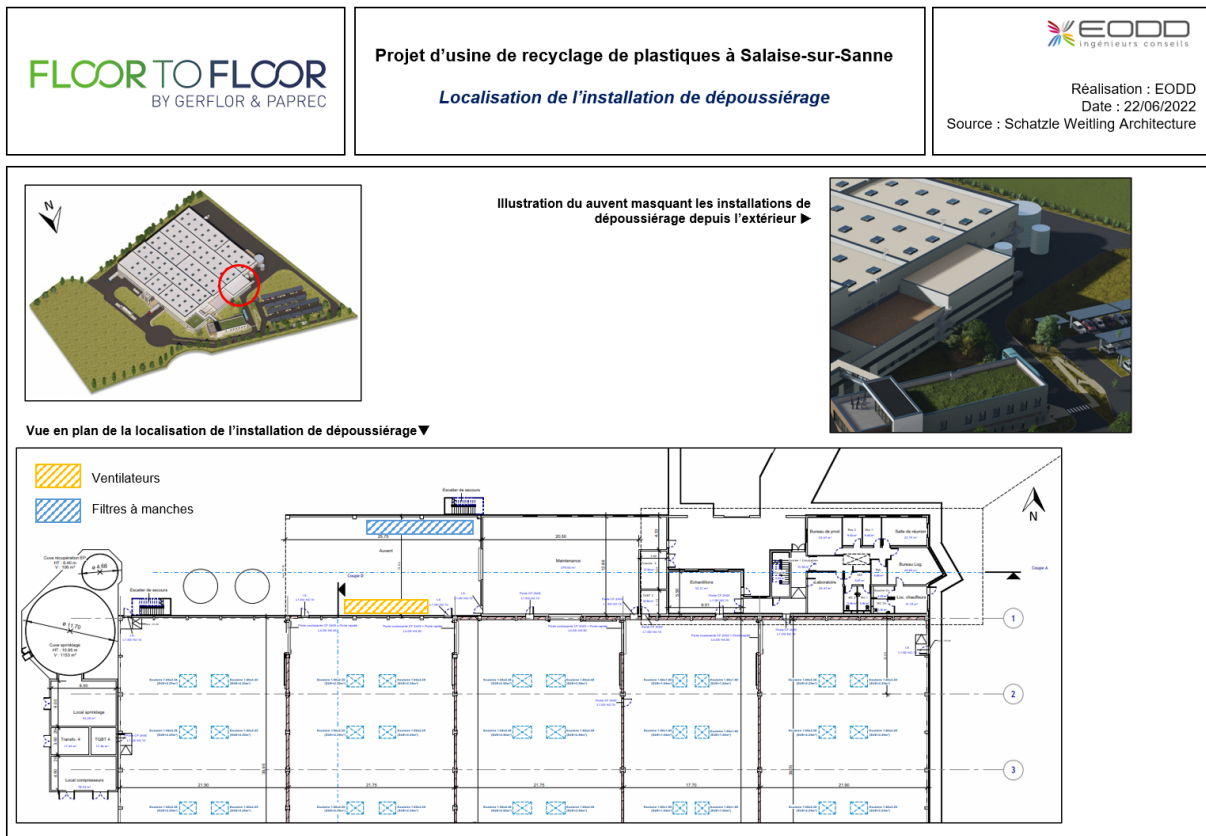
Figure 88 : Illustration de la zone accueillant la centrale de dépoussiérage
